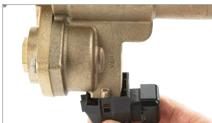
2. Enfoncez le capteur sur la soupape de décharge.
