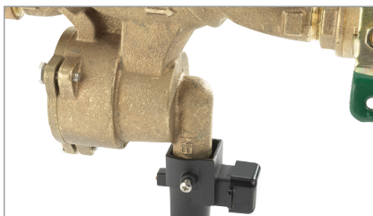
3. Veillez à ce que l'interface du capteur soit orientée dans la même direction que la flèche de débit de la vanne.
