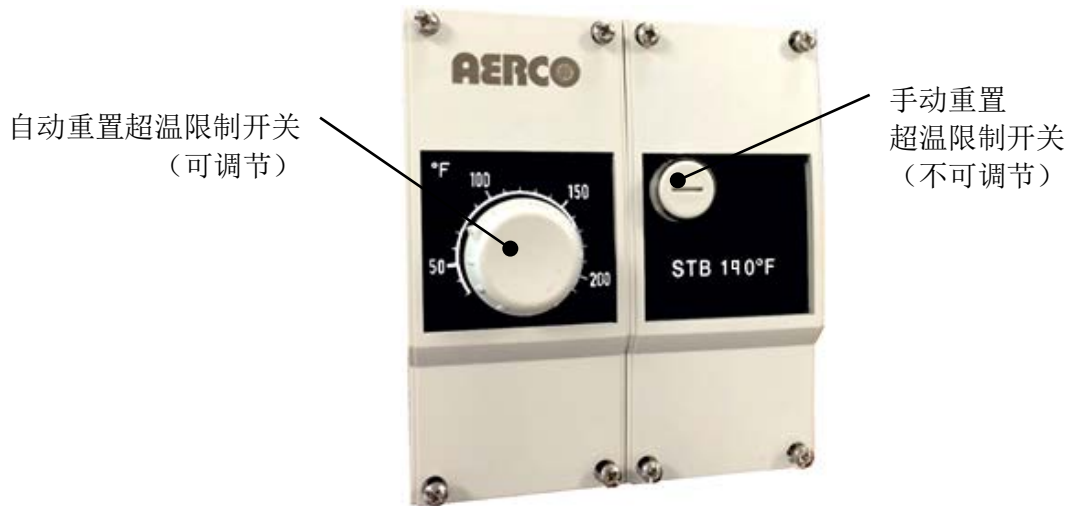
图 4-6.过温限制开关位置
